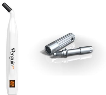
Рис.6 Прибор Penguin для RFA измерений с титановыми штифтами (мульти пегами)
